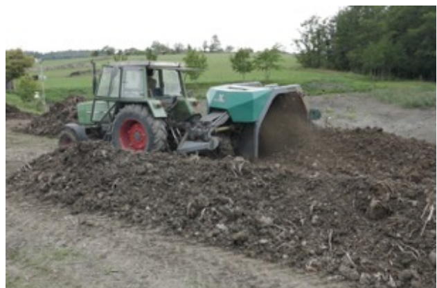
Figur 16 Första och andra passet med kompostblandaren. Här syns att växtdelarna brutits ned och materialet homogeniserats.
