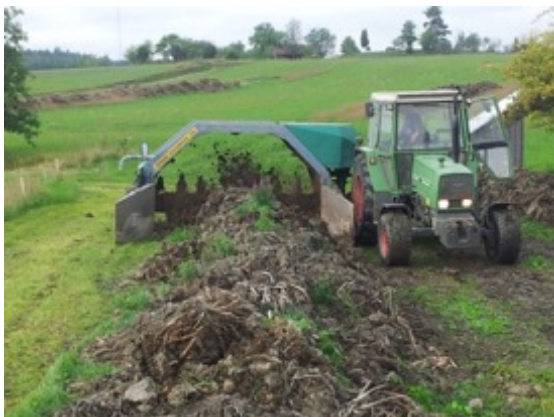
Figur 16 Första och andra passet med kompostblandaren. Här syns att växtdelarna brutits ned och materialet homogeniserats.
